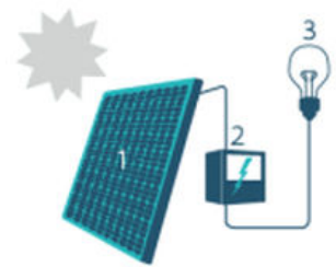
1. Zonnepaneel | 2. Omvormer | 3. Elektrische toestellen
